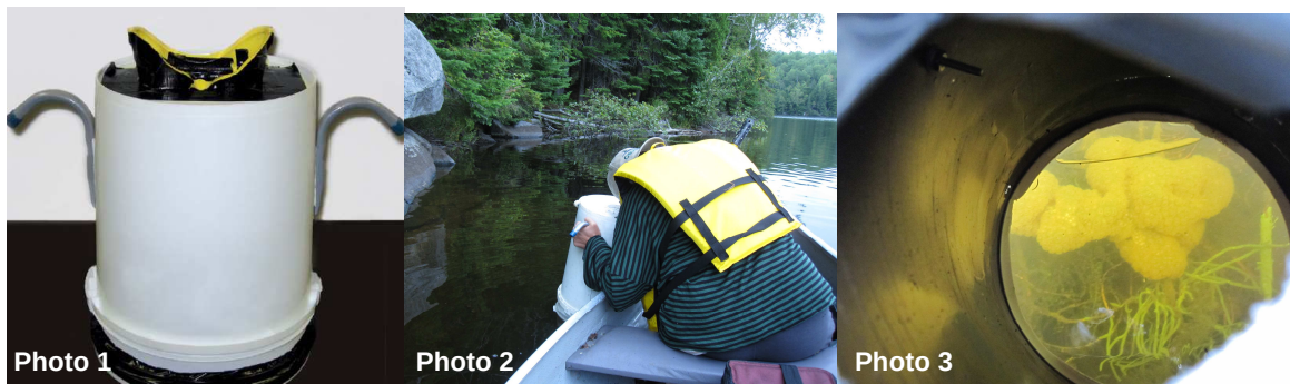
Photo 1 : Aquascope maison fabriqué à partir du protocole de Legendre, 2008. Photo : Legendre, 2008.
