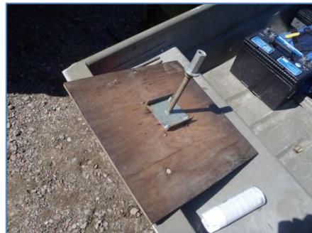
Afin de mesurer l'épaisseur (la profondeur) des sédiments lacustres (vaseux et meubles), un relevé a été pris à la surface des sédiments, avec la plaque de contre-plaqué, et un deuxième relevé a été pris au même endroit après avoir enfoncé la canne d'arpentage dans les sédiments, sans la plaque de contre-plaqué. Cette opération a été effectuée pour les six points dans la zone 1 (carte, annexe 1).
