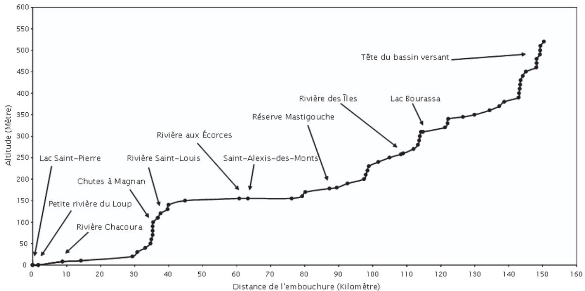
Figure 3.1 : Profil longitudinal de la rivière du Loup. Source : MRNF, 2000
